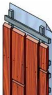
Abbildung 5 - Vertikale offene Fassadenverkleidung (Quelle: Centrum Hout, 2018)
